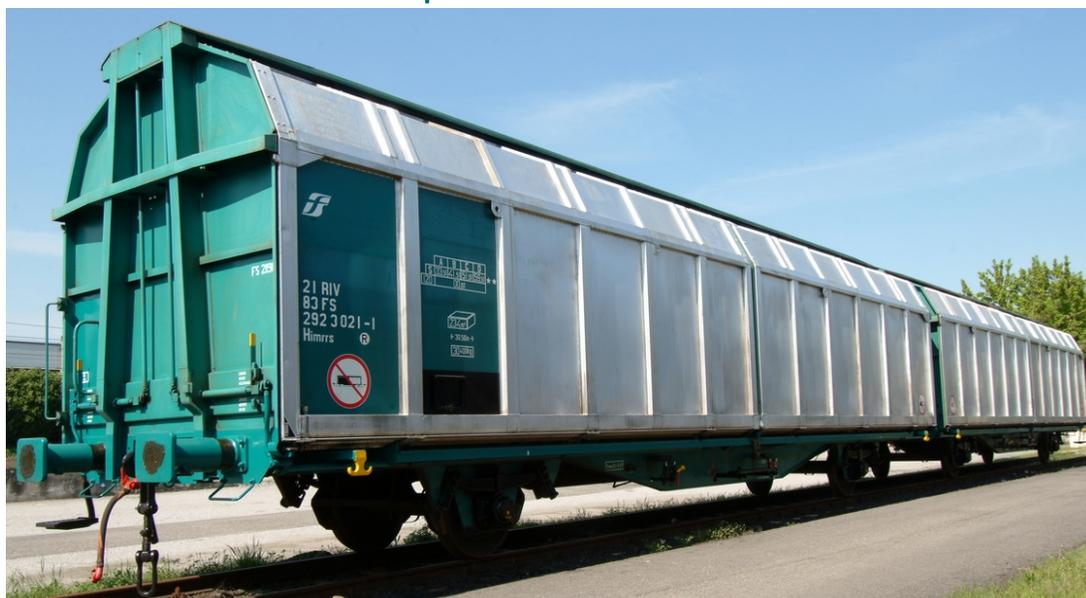
*Carro multiplo composto da due elementi specializzato per merci palettizzate. Ha il pavimento in legno dello spessore di 45 mm. Può circolare isolato con o senza carico su raccordi aventi raggio di curvatura minimo di 75 m.*
