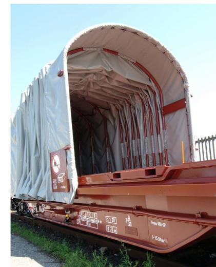
*Può circolare isolato con o senza carico su raccordi aventi raggio di curvatura minimo di 75 m. Può transitare sulle rampe dei ferry-boat con curva e controcurva di 120 m di raggio e inclinazione carrello 1°30'.*
