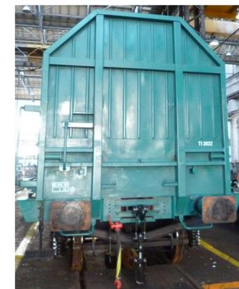
*Può circolare isolato con o senza carico su raccordi aventi raggio di curvatura minimo di 35 m. Può transitare sulle rampe dei ferry-boat con curva e controcurva di 120 m di raggio e inclinazione carrello 3°30'. E' conforme alle normative internazionali vigenti.*
