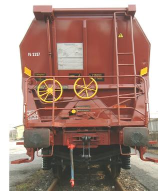
*Carro a tetto apribile a scarico massiccio per gravità, bilaterale, destinato al trasporto di merce alla rinfusa, anche ad elevato peso specifico (7-8 kg/dmc) che teme l'umidità. Ha guarnizioni che permettono il trasporto di merce con granulometria inferiore a 2 mm. E' suddiviso in due compartimenti con portelloni laterali (uno per lato per ogni compartimento) ad apertura e chiusura*
