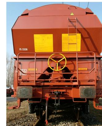
*Il carico si effettua dall'alto tramite benne, nastri trasportatori o attrezzatura opportuna. Può circolare isolato con o senza carico su raccordi con raggio di curvatura minimo 75 m. Può transitare sulle rampe dei ferry-boat con curve e controcurve di 120 m di raggio e con inclinazione carrello di 2°30'. E' conforme alle normative internazionali vigenti.*
