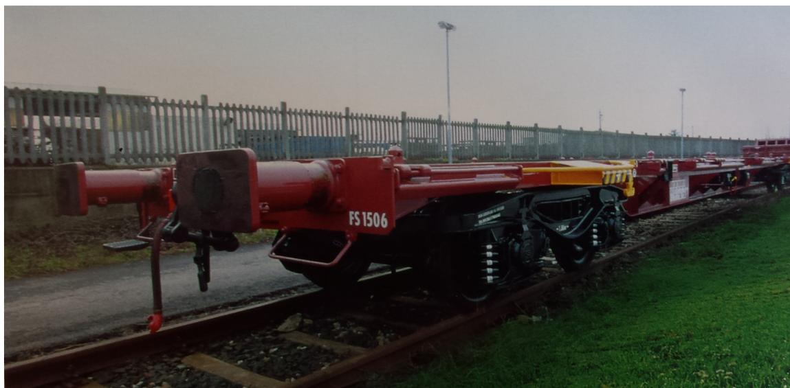
*Carro atto al trasporto di container e casse mobili. E' dotato di 16 caviglie ribaltabili in 36 posizioni per il bloccaggio dei container e di 6 sostegni intermedi per casse mobili. Il carro deve essere caricato e scaricato solo con movimentazione verticale. Le casse mobili devono essere sollevate tramite gru equipaggiate con presa per pinze.*
