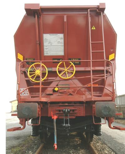
*Può circolare isolato con o senza carico su raccordi con raggio di curvatura minimo 75 m. Può transitare sulle rampe dei ferry-boat con curve e controcurve di 120 m di raggio e con inclinazione carrello di 2°30'. E' conforme alle normative internazionali vigenti.*
