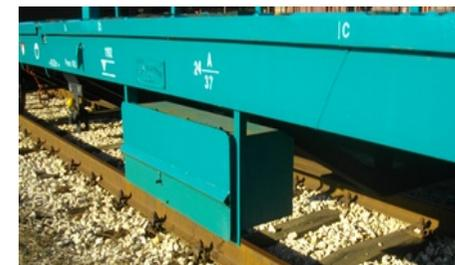
*Pianale attrezzato con 56 dispositivi di ancoraggio aggiuntivi, 2 contenitori contenenti 24 cinghie complete di cricchetti, destinato prevalentemente al trasporto di trattori. E' dotato di 12 stanti laterali scorrevoli, 12 dispositivi di arresto per transcontainer incorporati nel pavimento, 16 ganci di ancoraggio, 4 stanti scorrevoli di testa, 2 sponde ribaltabili sulle testate.*
