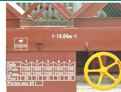
*Il carro è dotato di protezioni fisse, per contenere i rotoli, ai lati delle selle e di due pedane di calpestio. Può circolare isolato, con o senza carico, su raccordi aventi un raggio di curvatura minimo di 35 m e può transitare sulle rampe dei ferry-boat con curva e controcurva di 120 m di raggio e inclinazione carrello 3°30'. E' conforme alle normative internazionali vigenti.*
