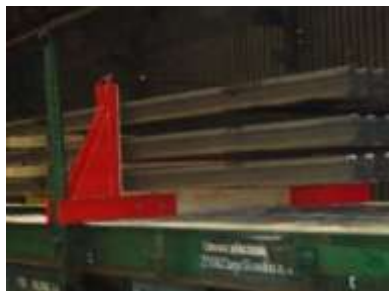
Telaio posizionato sul carro
